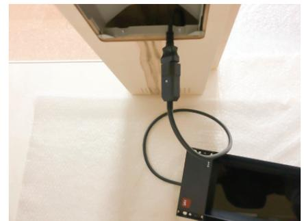
Sie können den Infrarotstrahler nun vorsichtig ins Gehäuse einführen. Achten Sie dabei darauf, keine Kabel einzuklemmen. Fixieren Sie den Strahler an den äußersten Schraubenlöchern im Gehäuse.
