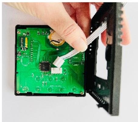
Quindi guidare il cavo dati attraverso l'apertura e collegarlo con attenzione alla presa bianca sulla parte anteriore del display finché non scatta in posizione.
