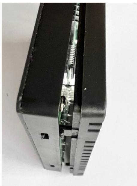
Infine, agganciare con cura la parte anteriore all'alloggiamento posteriore. Può essere aperto di nuovo in seguito utilizzando le schede, se necessario.
