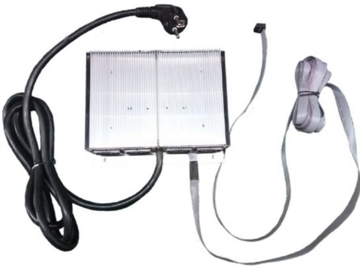
La unidad de potencia icon 4 se monta en el techo de la cabina, en la pared de la cabina o de acuerdo con las recomendaciones del fabricante usando tornillos a través de las aberturas para tornillos provistas. La unidad de potencia emite calor, así que asegúrese de que haya una ventilación adecuada. La unidad de potencia no debe estar cubierta. Una
