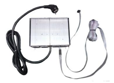
L'unità di alimentazione icon 4 viene montata sul soffitto della cabina, sulla parete della cabina o secondo le raccomandazioni del produttore utilizzando le viti attraverso le aperture per le viti fornite. L'unità di alimentazione emette calore, quindi assicurare una ventilazione
