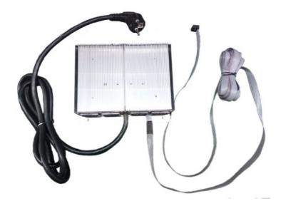
L'unité d'alimentation icon 4 est montée au plafond de la cabine, sur le mur de la cabine ou selon les recommandations du fabricant à l'aide de vis à travers les ouvertures de vis fournies. Le bloc d'alimentation émet de la chaleur, assurez-vous donc d'une ventilation adéquate. Le bloc d'alimentation ne doit pas être couvert. Une installation incorrecte sans ventilation peut endommager la partie puissance ou provoquer un incendie.
